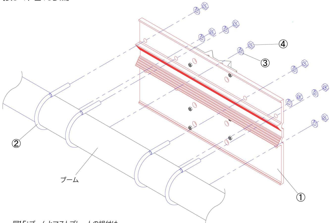
図15:ブームとマストプレートの組付け
