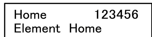
図 14 : エレメントがホームポジションまで戻った状態の LCD 画面です。
