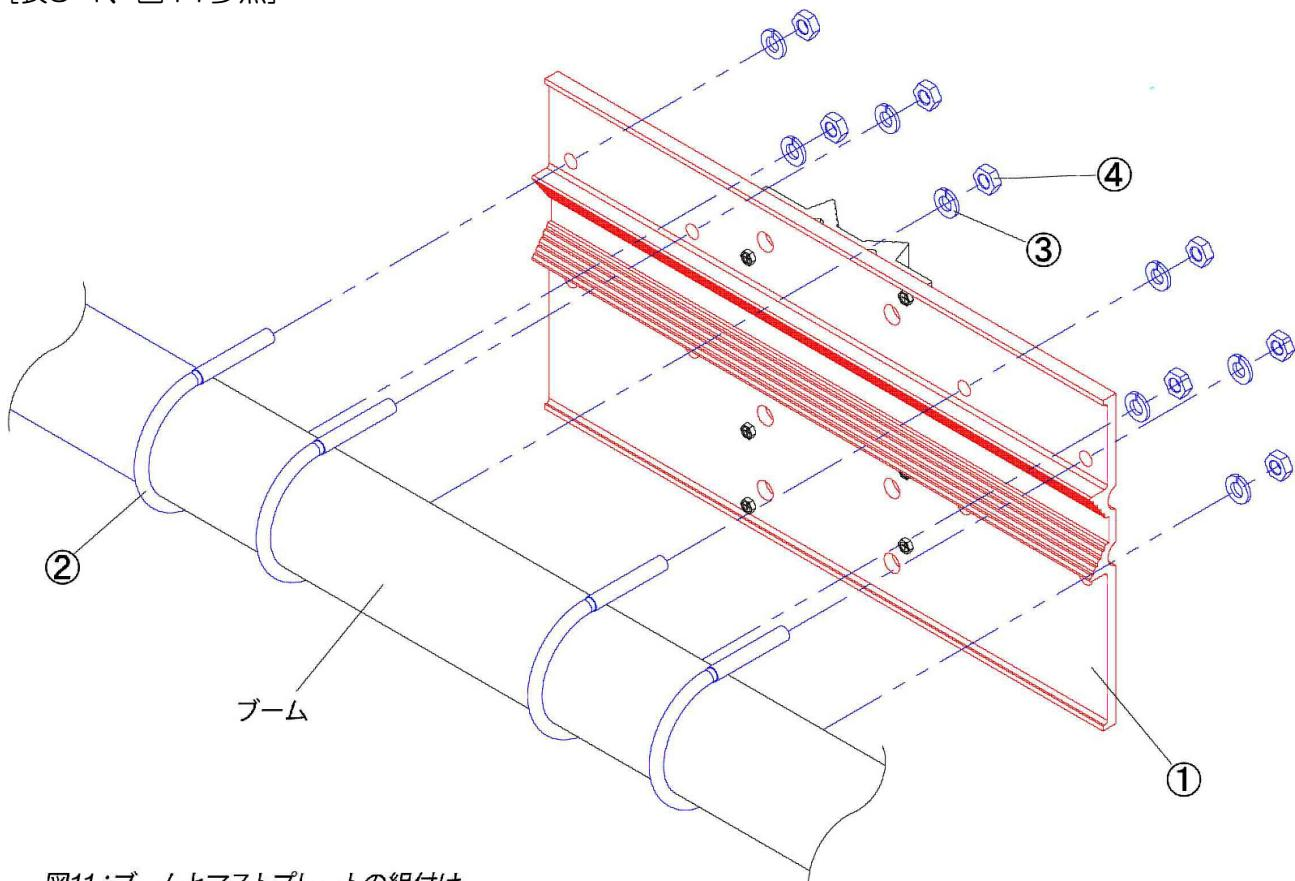
図11:ブームとマストプレートの組付け
