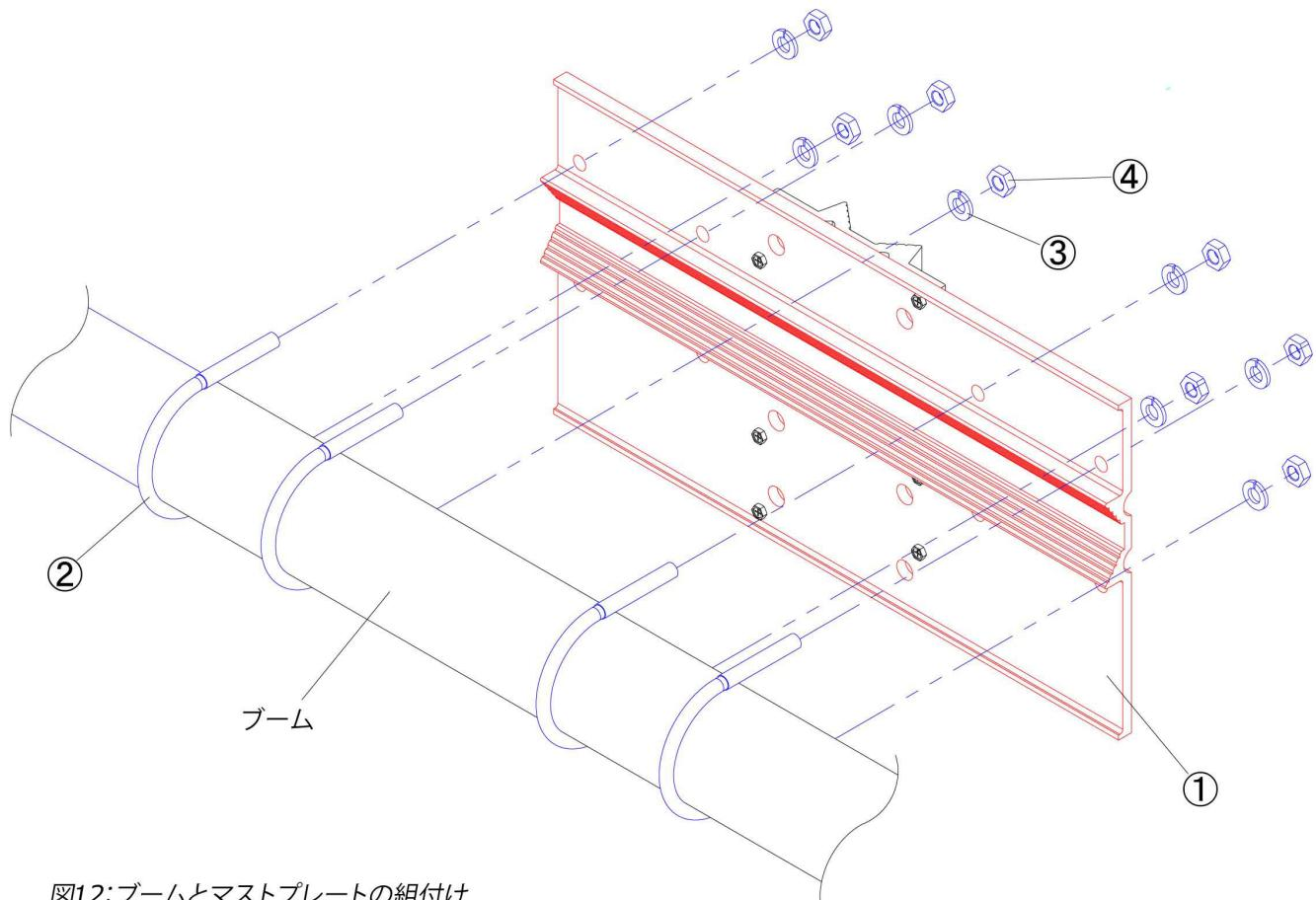
図12:ブームとマストプレートの組付け
